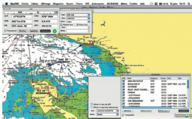
La cartographie Navionics sous MacENC avec, en haut à gauche, la fenêtre GPS et, en bas à droite, la liste des cibles AIS avec leur longueur en pieds, leur cap et leur vitesse.
